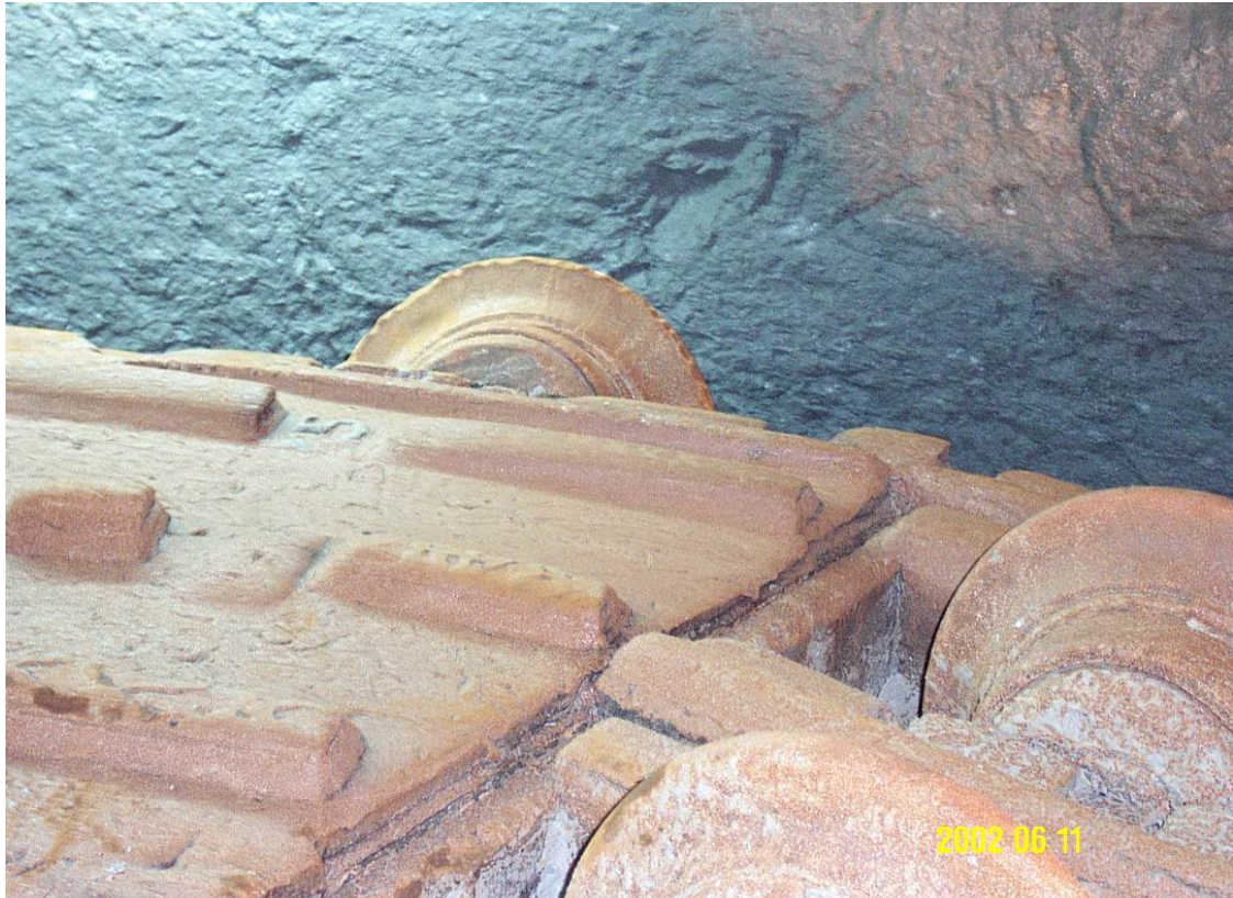
圖 11 削刀磨損情形
